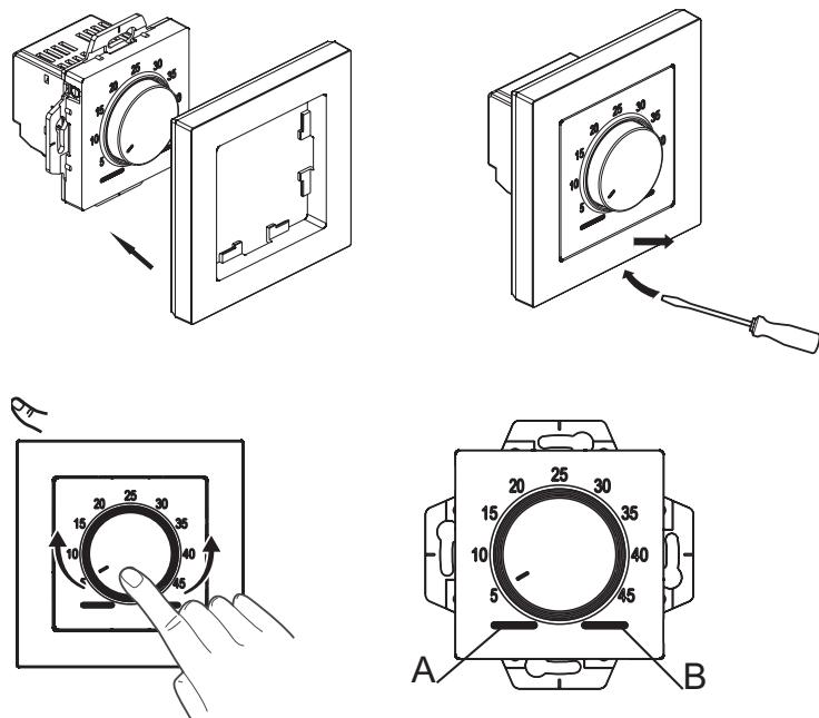
А Светодиод состояния (зеленый): загорается, если термостат включен
