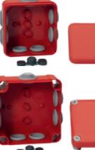
Коробки предназначены для соединения кабелей систем безопасности, отличаются высокой огнестойкостью и имеют красный цвет. На боковых стенках коробки расположены 7 сальников для ввода кабелей и труб диаметром до 20мм. На коробке 105x105 крышка дополнительно фиксируется с помощью винтов, поворачиваемых на четверть оборота. Степень защиты - IP55, механическая прочность - IK07. Огнестойкость – 960 °C. Материал: полипропилен.
