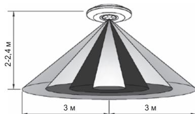
При высоте монтажа: 2-2,4 м
