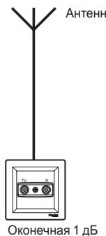
**Параллельное подключение (типа «звезда»)**
