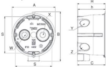
**Монтажные коробки для сплошных стен**
