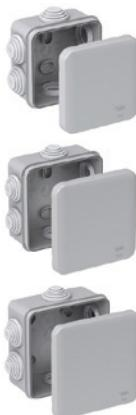
Используются для открытой установки. Имеют защелкивающуюся крышку, соединенную пластиковой ниткой с корпусом коробки, колпачки для колец, изолирующих крепёжные винты, и 6 ступенчатых сальников для ввода кабеля или гофротрубы. Сальники подходят для кабелей и труб диаметром 4...8, 8...12, 12...16 и 20 мм. Для коробки 100x100x50 сальники имеют диапазоны 4...8, 8...12, 12...16, 16...20 и 25 мм. Степень защиты – IP55, огнестойкость – 750 °C. Материал: полипропилен.
